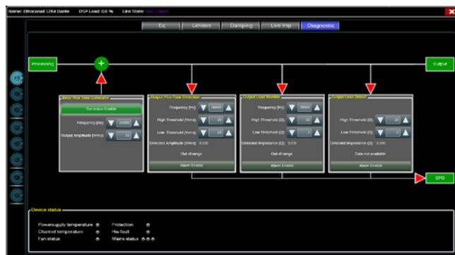
FIG. 5: GPO: Interfaz de monitoreo del sistema.
